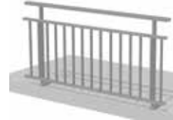
Barreaudage sous lisse intermédiaire
