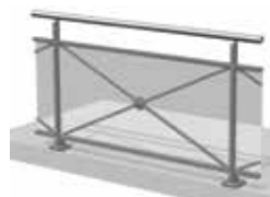
Bande filante sous lisse avec croix de Saint-André et main courante ronde
